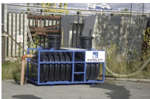
Mobil olieudskiller med sandfang.
